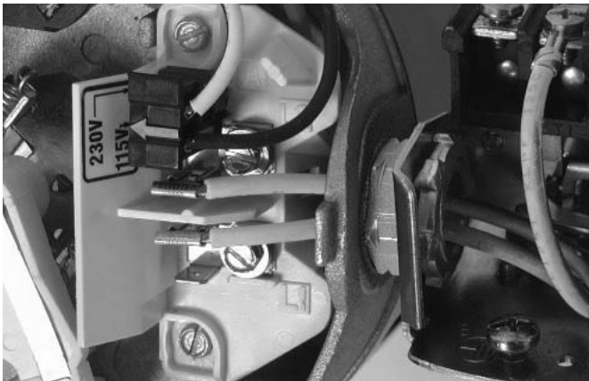
Figura 9: Tensión configurada para 115 voltios, tipo ficha.
