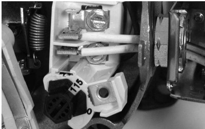
Figure 7 : Tension réglée à 115 volts sur sélecteur à cadran
