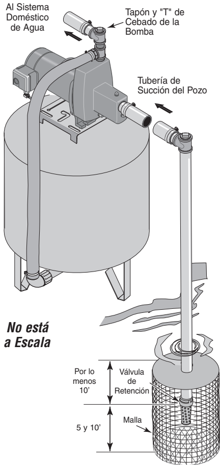
Figura 3: Instalación para agua superficial
