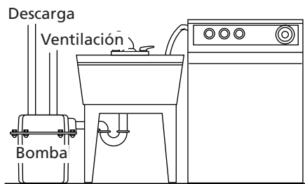
Figura 10 – Instalación típica en lavaderos y lavarropas
