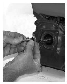
Figure 43: Insert Spacer
