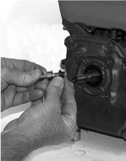
**Figure 43: Insert Spacer**
