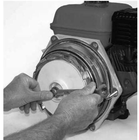
**Figure 52: Fasten Impeller**
