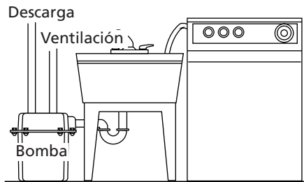
Figura 10 - Instalación típica en lavaderos y lavarropas
